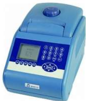
Figura 1. Termociclador empleado en el laboratorio de pertenencia del autor para la amplificación de muestras de ADN mediante la reacción en cadena de la polimerasa.
